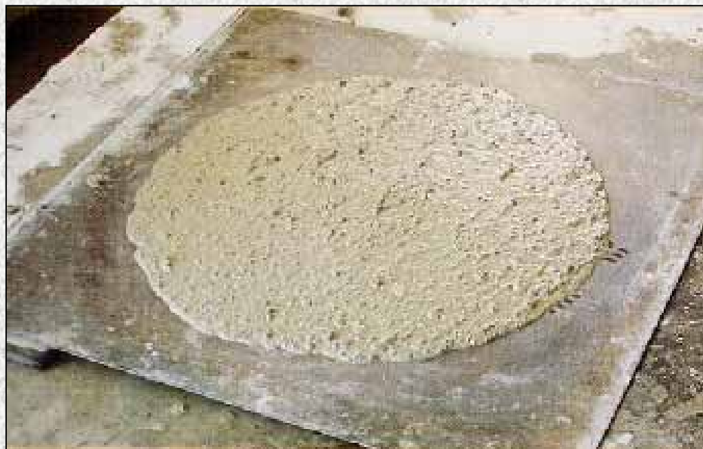
高流動コンクリート
